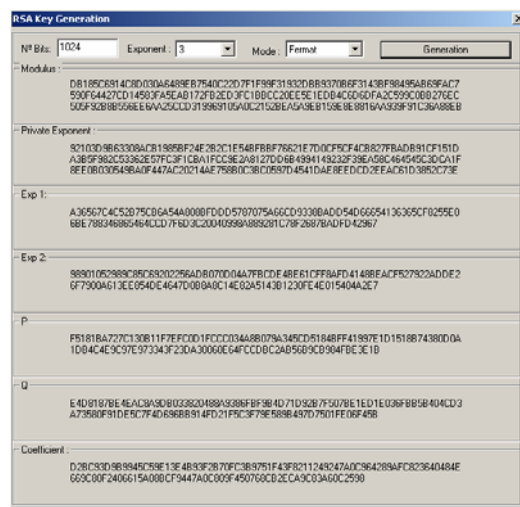
Figura 5. Detalle de generación de clave RSA.
